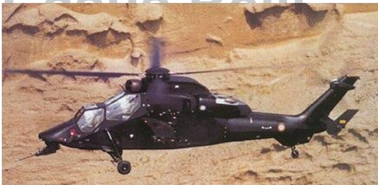
Prototipo de la versión HAP, armado con el cañón de 30 mm en la nariz y los sensores sobre la cabina del artillero. El Tigre es un helicóptero esbelto, de gran maniobrabilidad y muy ligero.
